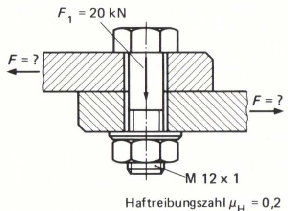
$$F = \mu \cdot F_1 = 0,2 \cdot 20 \text{ kN} = 4 \text{ kN}$$
