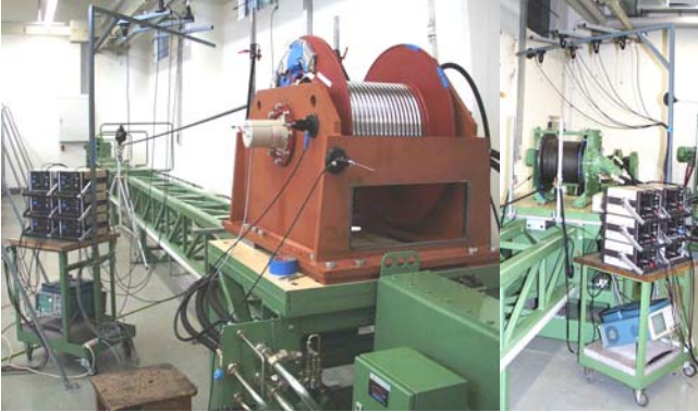
Bild 6: Seiltrommelprüfstand mit Telemetrie
