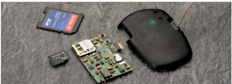
Bild 4: Mobiles MicroLogger (65 mm x 45 mm x 10 mm – l x b x h) /4/
