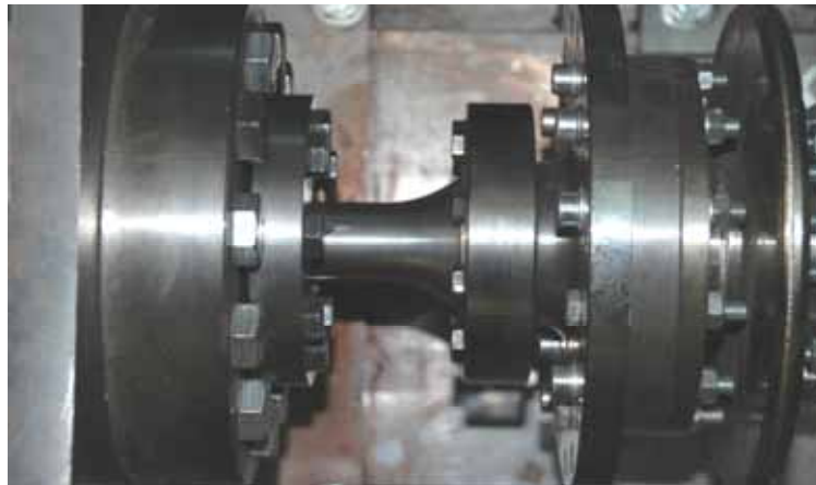
Bild 4: Einspannsituation im Torsionsschwingprüfstand
