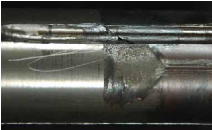
Bild 6: Torsionsbruch an Probe Geometrie 4
