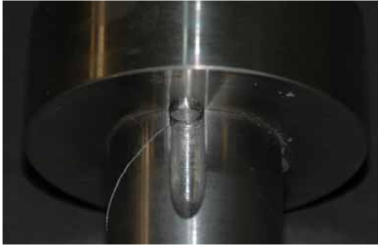
Bild 5: Torsionsbruch an Probe Geometrie 4
