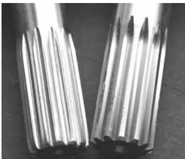
Bild 2 und 3: Beide Auslaufformen am Beispiel von Prüflingen mit geschliffener Verzahnung
