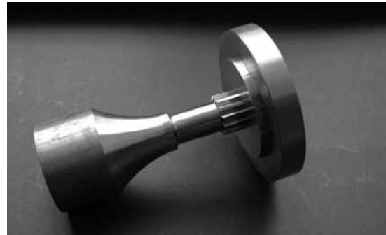
Bild 6 Prüfling und Nabe im gefügten Zustand
