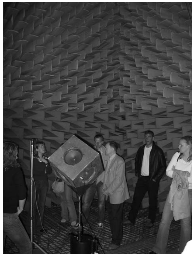
Bild 2: Schalltoter Raum für akustische Versuche.
