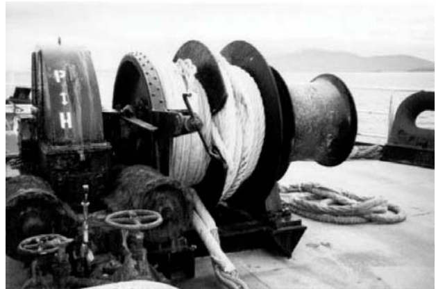
Bild 4: Mehrlagig bewickelte Trommel mit einem 12fach geflochtenen 4,5 mm Kunststoffseil aus hochmoduligen Polyethylen-Fasern (Dyneema) /1/
