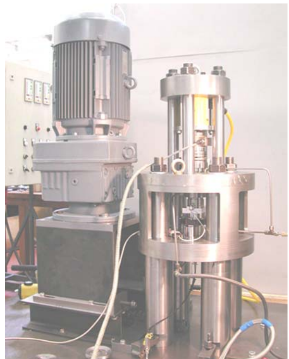
Bild 17: Gesamte Ansicht des Druckkammprüfstandes ohne Rechner
