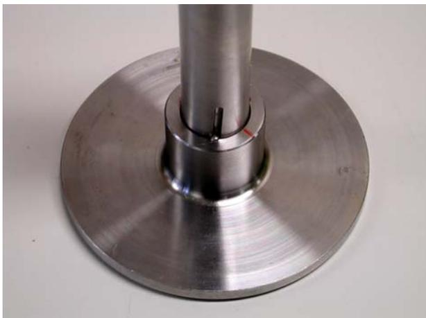
**Bild 4:** Verbindung 3W6\_N3.  $n_s = 3$ ,  $l_f/D_{al} = 1$
