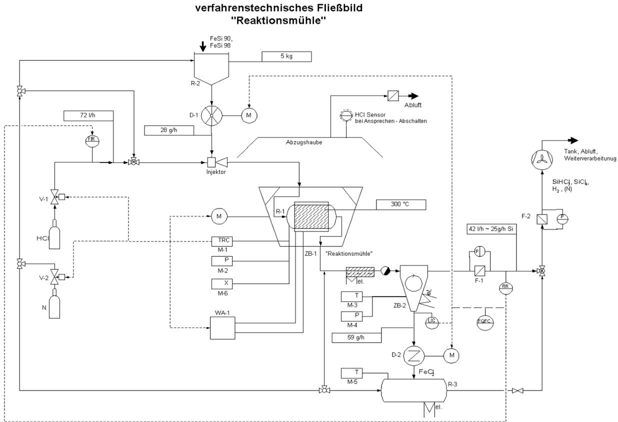
**Bild 4:** Verfahrensfliessbild der Reaktionsschwingmühle
