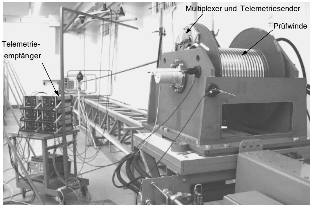
Bild 6: Meßaufbau (Trommel, Prüfstand, Telemetrieanlage)
