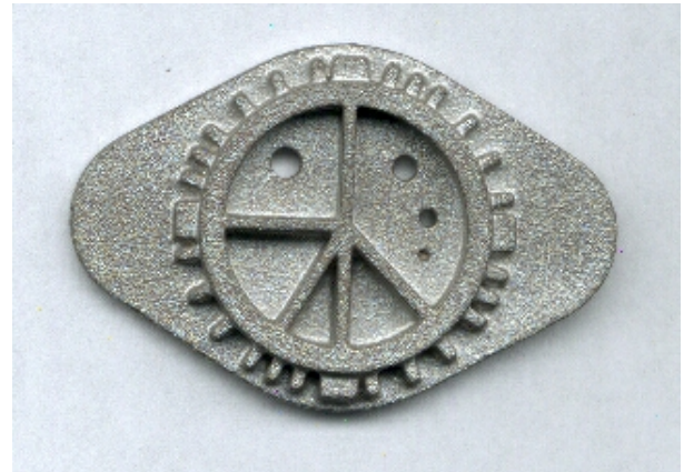
Bild 3: mit Zinn infiltrierter Probekörper
