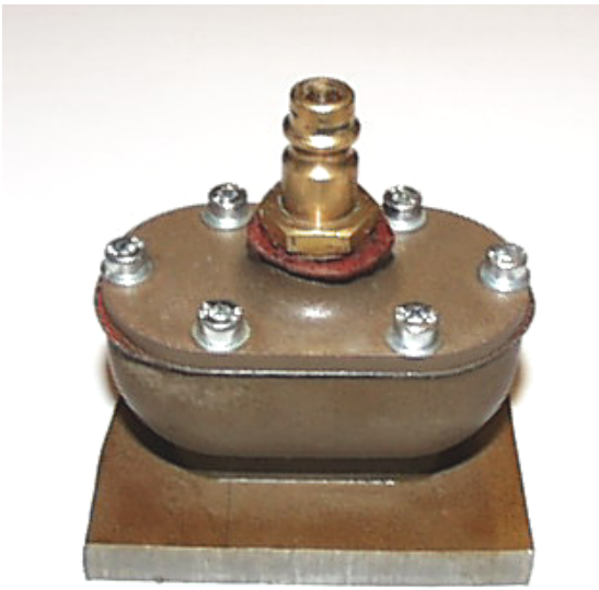
Bild 1: mit Epoxid-Harz infiltrierter Druckbehälter
