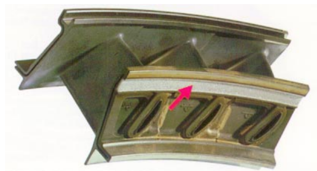
Bild 12: Verschleisschutzschicht aus Chromkarbid-Nickelaluminium an einer Turbinenleit-schaufel /7/
