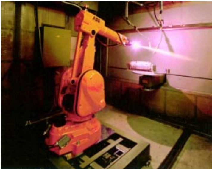
Bild 7: Roboter mit Handlingsystem beim Plasmaspritzen einer Triebwerksbrennkammer /5/
