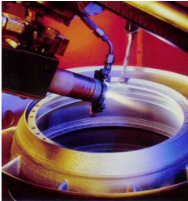
Bild 5: Maskiertes Bauteil während des Plasmaspritzvorganges /7/
