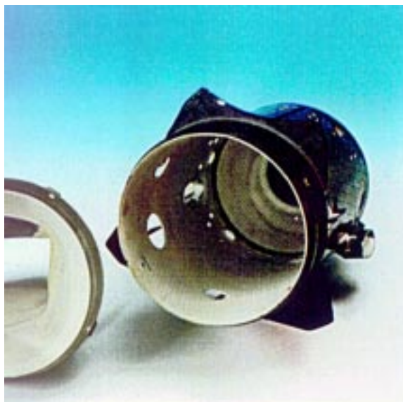
Bild 15: Mit Zirkoniumoxid beschichtete Brennkammer /5/
