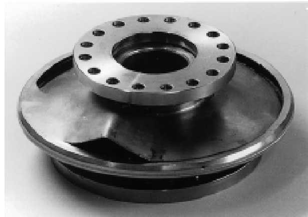
Bild 10: Dauerbruch einer Membrankupplung im Versuchsbetrieb infolge zu hoher Umlaufbiegebelastung
