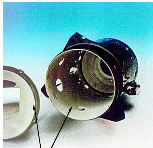
Funktionsflächen geschützt durch Wärmedämmschichten
